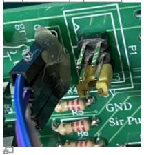
Platine mit angeschlossenem LCD und Pull DOWN Einstellung für Relais Board
